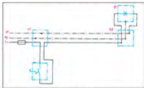
شکل ۲-۲۰- شمای حقیقی مدار کلید یک پل
