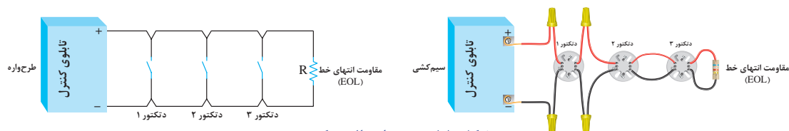
شکل ۵۵- نحوه اتصال دکتور
