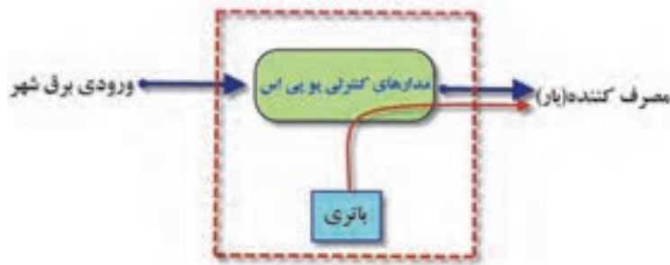
شکل ۳- مدار کنترلی یو پی اس
