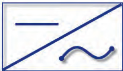
شکل ۴- تبدیل ولتاژ مستقیم به متناوب
