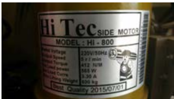
شکل ۱۲- موتور در کرکره ای از نوع سایید با ولتاژ ۲۲ ولت برای در ۶۰۰ کیلوگرمی
