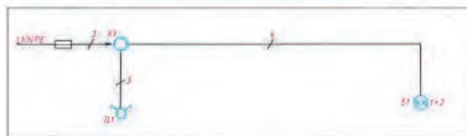
شکل ۳۰ - ۳- شمای فنی مدار کلید دویل
