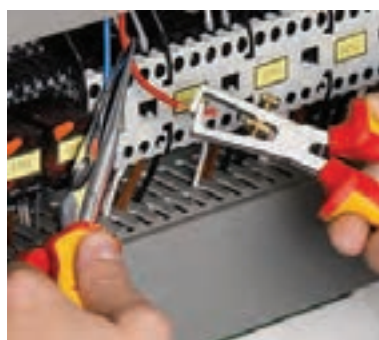
شکل ۱-۹- روکش برداری با سیم لخت کن دستی
