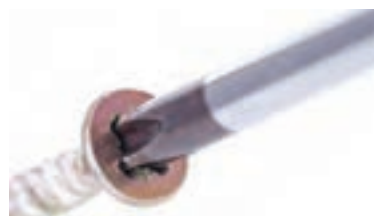
(الف) استفاده صحیح از آچار پیچ گوشتی
