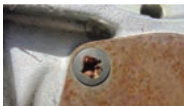
(ب) استفاده ناصحیح از آچار پیچ گوشتی
