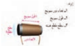
شکل ۳-۸- پارامترهای مهم در یک سلف
