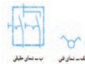
شکل ۲-۱۵- علامت اختصاری کلید دابل
