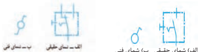
شکل ۲-۱۷- شماهای فنی و حقیقی کلید تبدیل
