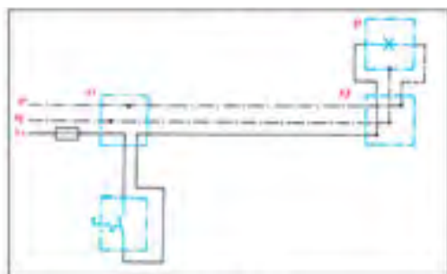
شکل ۲-۲۰- شمای حقیقی مدار کلید یک پل
