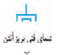
شکل ۲-۱۳- علامت اختصاری پریز تلفن و آنتن
