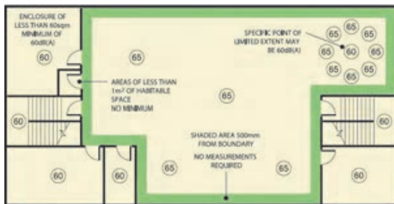
شکل ۶ - شدت صوت هشدار دهنده در فضاهای مختلف
