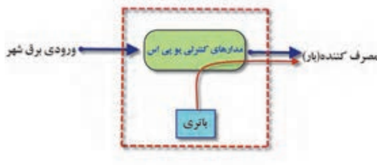
شکل ۳- مدار کنترلی یو پی اس
