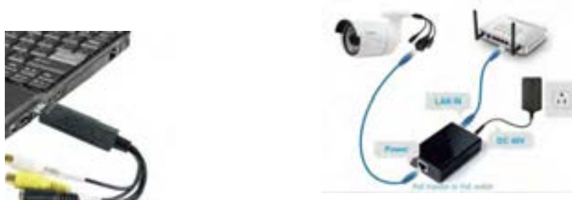
شکل ۲۸ - اتصال دوربین IP
