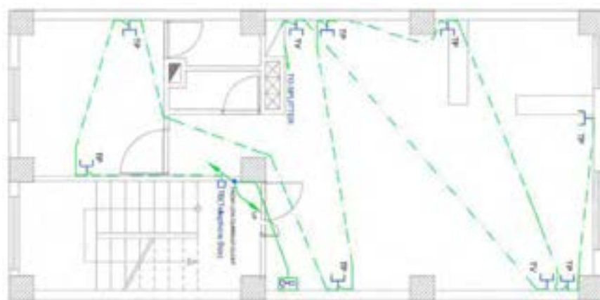
شکل ۱۰ - نقشه سیم‌کشی پریز تلفن و پریز آنتن
