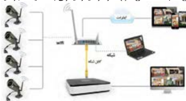
شکل ۲۸ اتصال دوربین های IP
