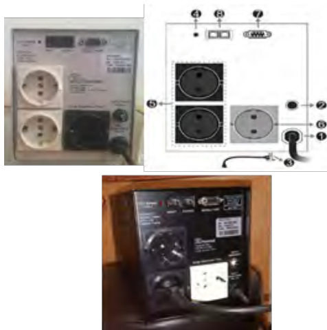
شکل ۸- اتصالات پشت یو پی اس
