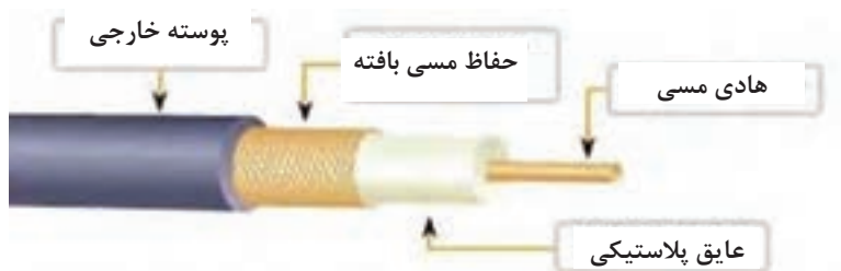
شکل ۳- اجزای کابل کوآکسیال
