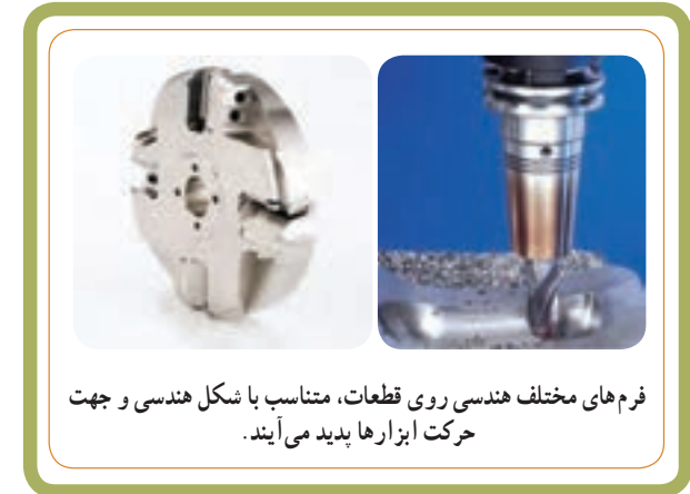
ایجاد شکاف‌ها و شیارها، توسط ابزارهای مختلف
