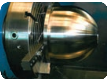
۶ به سطح کروی روی قطعه ماشین‌کاری شده توجه کنید.
