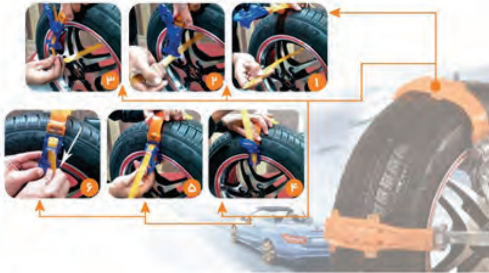
شکل ۱۲-۵- نحوه بستن زنجیر چرخ
