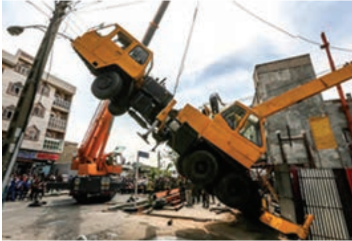
شکل ۵-۵- واژگونی جرثقیل به علت جابه‌جایی بیش از اندازه
