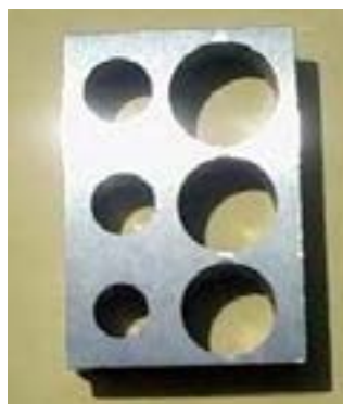
شکل ۴-۲۲- قطعه کار پس از عملیات برقکاری
