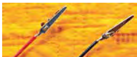
شکل ۱-۶۹ - لحیم کاری گیره سوسماری
