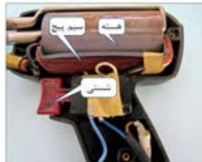
شکل ۹۶-۱ - چگونگی باز کردن هویه هفت تیری و اجزاء آن
