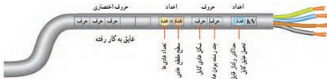
شکل ۱-۲ - مشخصات فنی یک نوع کابل
