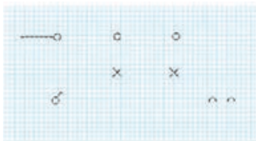
شکل ۲-۵۲- تکمیل نقشه‌های مدار کلید دو پل
