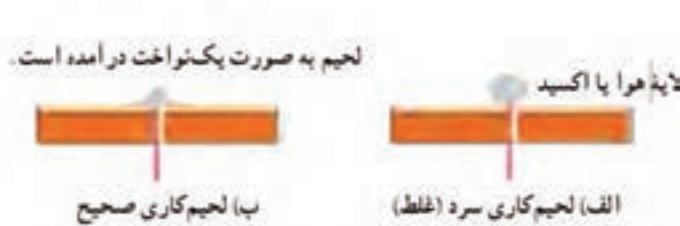
شکل ۵۰-۱- لحیم کاری صحیح و غلط
