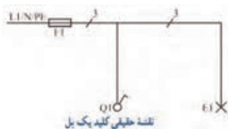
شکل ۲-۳۲- نقشه فنی مدار کلید یک پل و لامپ
