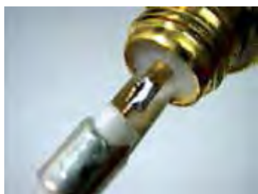
شکل ۱-۷۰- اتصال کابل کوآکسیال به فیش آنتن
