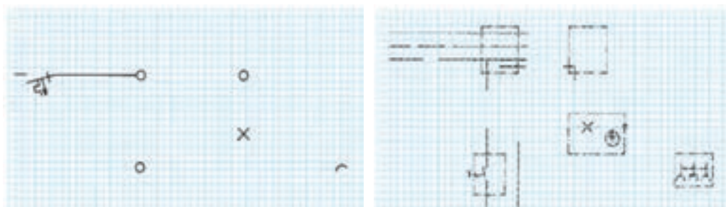
شکل ۲-۳۵ - تکمیل نقشه فنی و حقیقی کلید یک پل و پریز
