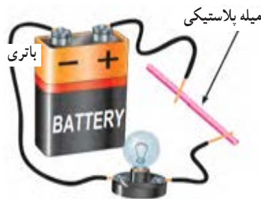
شکل ۲۰-۱- برقرار نشدن جریان الکتریکی در عایق
