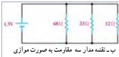
شکل ۶۶-۱ - سه مقاومت به صورت موازی
