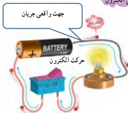
شکل ۲۳-۱- جهت جریان الکتریکی
