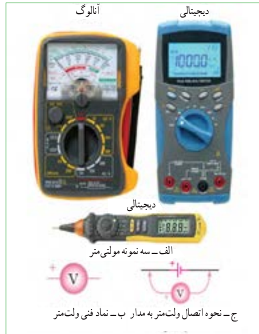
شکل ۵۵-۱- ولت متر و نماد آن
