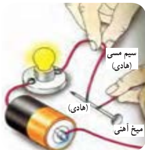
شکل ۱۹-۱- برقراری جریان الکتریکی در هادی
