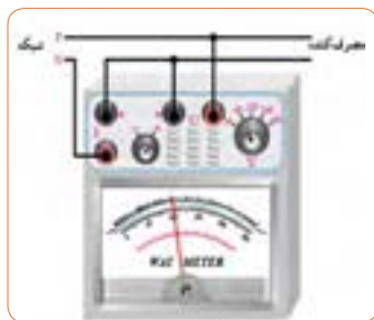
شکل ۱۰۲- نحوه اتصال وات متر به شبکه برق شهر و مصرف کننده
