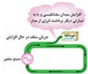
شکل ۹۶ - ذخیره انرژی در سیم‌پیچ
