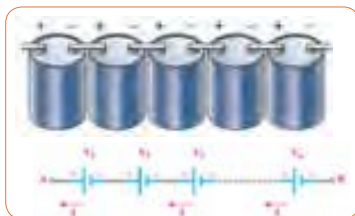
شکل ۲۴- اتصال سری پیل‌ها
