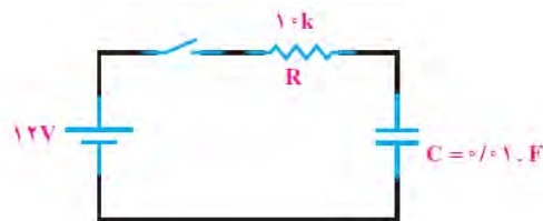
الف - مدار RC سری در جریان مستقیم
