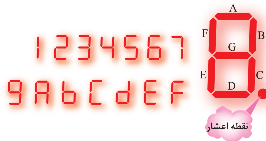
شکل ۱۳-۴۷- روشن کردن هفت قطعه‌ای
