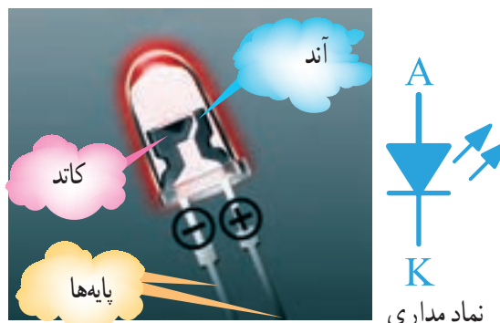
شکل ۳۰-۱۳ نماد فنی و ساختمان داخلی LED
