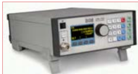
شکل ۴۳-۳- دو نمونه دستگاه سیگنال ژنراتور
