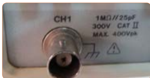
شکل ۷۲-۴- ورودی اسیلوسکوپ
