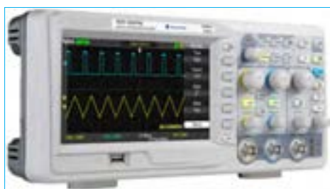
شکل ۵۴-۴- یک نمونه اسیلوسکوپ با صفحه نمایش LCD
