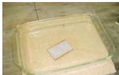
شکل ۱۰-۷- قراردادن فیبر با کاغذ چسبیده در آب جوش
