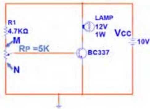
شکل ۱۱-۴- مدار آزمایش هدایت ترانزیستور
