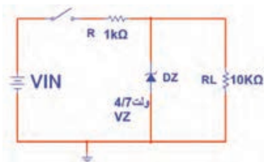
شکل ۳-۶۹- مدار آزمایش رگولاتور با زنر
