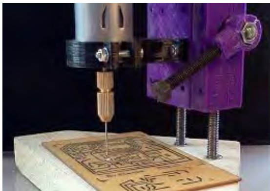
شکل ۷-۱۸- سوراخ کاری پایه قطعات با مته مناسب
