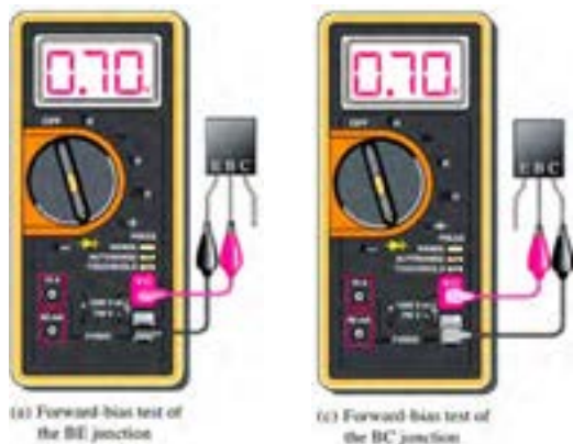
شکل ۴-۳ تشخیص پایه بیس ترانزیستور با مولتی‌متر دیجیتالی
