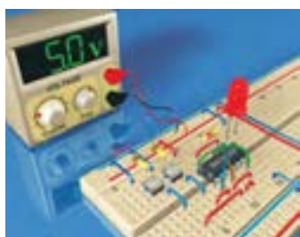
شکل ۷-۴- بستن مدار روی بردبرد و آزمایش آن
