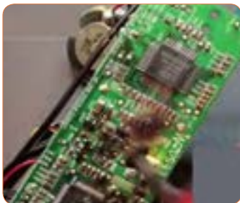
شکل ۵-۵ - قطعاتی از برد سوخته است.
