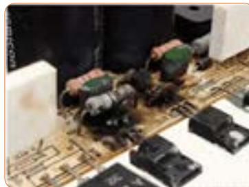
شکل ۲۴-۵ - آسیب قطعات در یک برد
