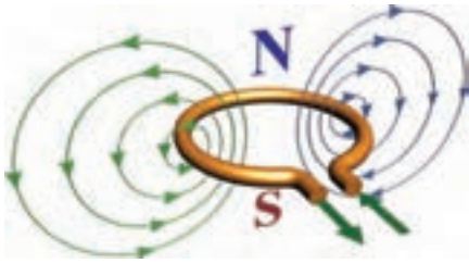
شکل ۱۷-۸ - میدان مغناطیسی حاصل در یک حلقه
