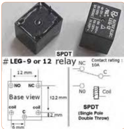
شکل ۱۰۹- مشخصات فنی یک نمونه رله
