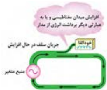
شکل ۹۶ - ذخیره انرژی در سیم‌پیچ
