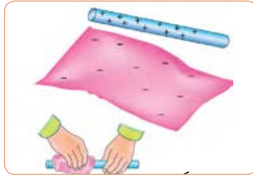
شکل ۴- پس از مالش دادن یک میله شیشه‌ای به پارچه ابریشمی، آنها دارای بار الکتریکی می‌شوند.
