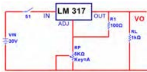
شکل ۳-۸۲- مدار آزمایش با آی سی رگولاتور متغیر
