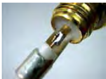
شکل ۱-۷۰- اتصال کابل کوآکسیال به فیش آنتن
