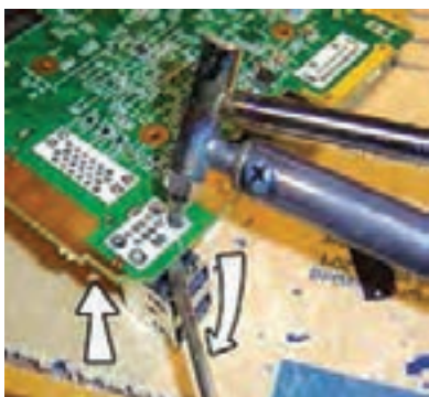
شکل ۸۷-۱- استفاده از قلع کش حرارتی
