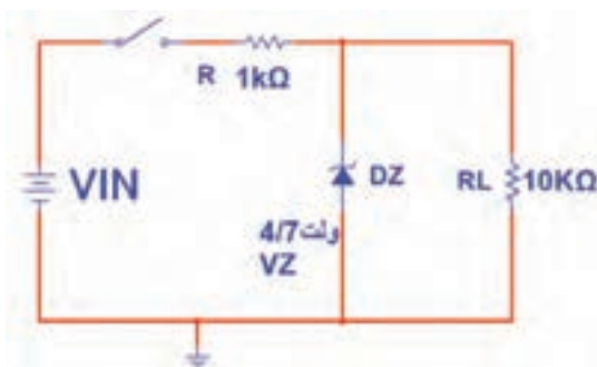
شکل ۳-۶۹- مدار آزمایش رگولاتور با زنر
