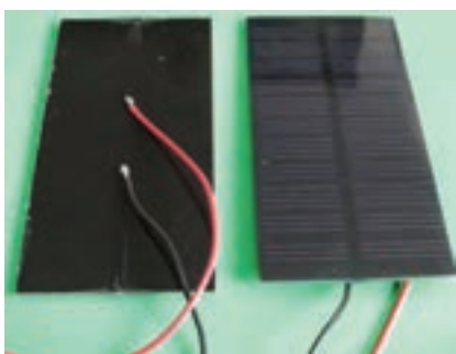
شکل ۳-۹۴- سلول خورشید و اتصال سیم به آن
