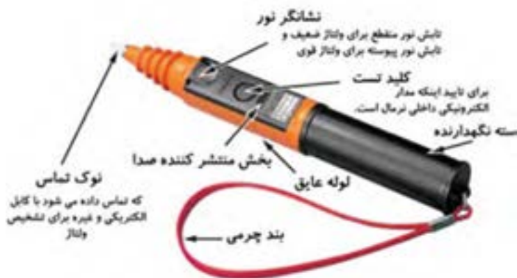
شکل ۳۸-۲- ساختمان داخلی فازمتر دیجیتالی
