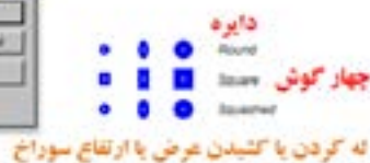
شکل ۶-۳۵- تعیین ویژگی‌های Padها
