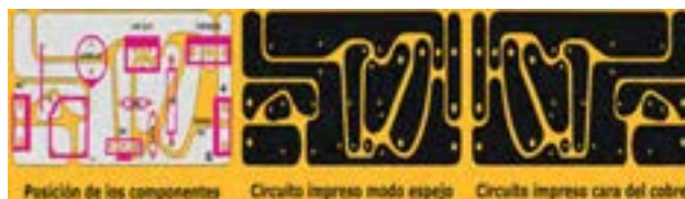
شکل ۲۰-۵- طراحی مدار چاپی و نقشه معکوس مدار چاپی
