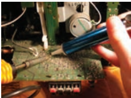
شکل ۸۴-۱ - مراحل ذوب شدن و مکش قلع
