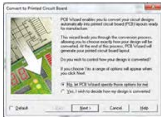
شکل ۶-۶۱- پرسش از کاربر برای تصمیم گیری چگونگی تبدیل مدار به طرح مدار چاپی
