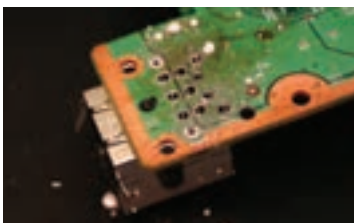
ب- برداشتن لحیمها و آزاد کردن پایهها
