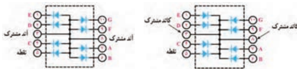
الف- مدار آند مشترک
