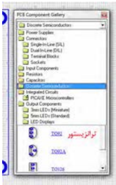
شکل ۴۹-۶- انتخاب پایه‌های ترانزیستور BC547
