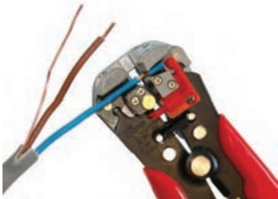
شکل ۲۱-۱- روکش‌برداری با سیم لخت کن خودکار
