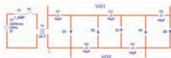
شکل ۳-۸۷- مدار پنج برابر کننده ولتاژ
