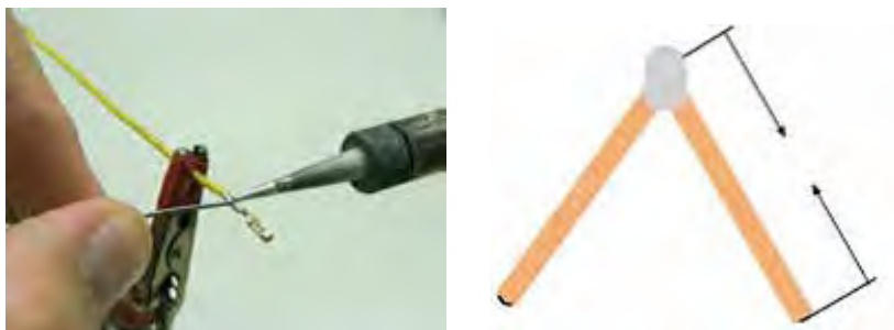
شکل ۱-۵۷- ساخت زاویه ۳۰ درجه
