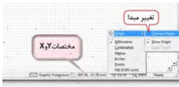
شکل ۲۸-۶- Origin و تعیین واحد مختصات X و Y
