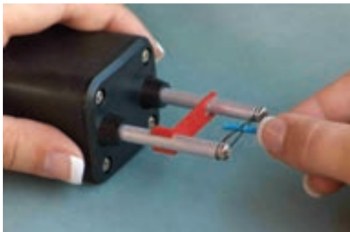
شکل ۱-۲۳ - سیم لخت‌کن ساده و حرارتی
