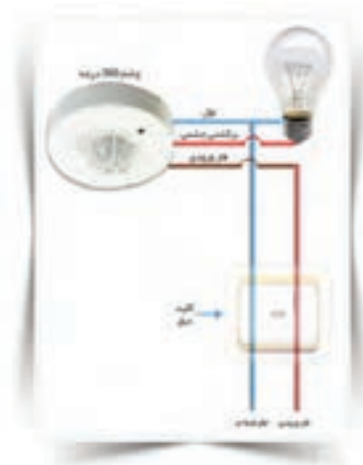
شکل ۲-۷۱- یک نمونه نقشه رله چشمی راه پله
