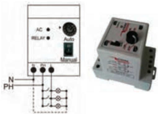
شکل ۲-۷۰- نمونه واقعی اتصال رله راه پله
