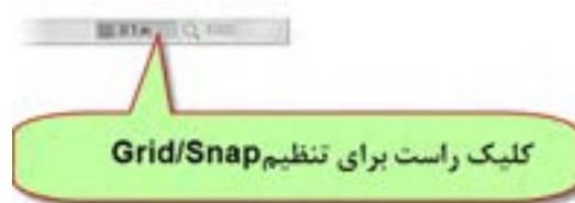
شکل ۴۱-۶ مسیر تنظیم Grid/Snap
