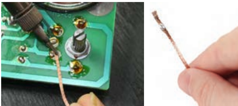
شکل ۸۰-۱ - برداشتن قلع از روی فیبر
