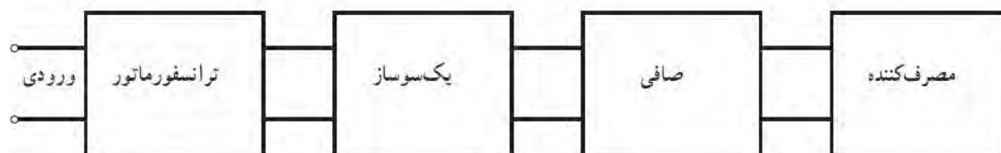
شکل ۳-۵- بلوک دیاگرام یک منبع تغذیه ساده
