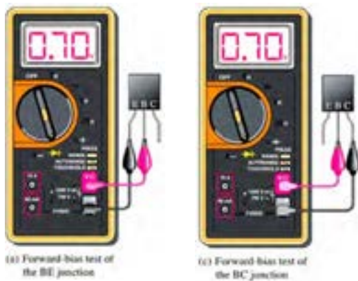
شکل ۴-۳ تشخیص پایه بیس ترانزیستور با مولتی‌متر دیجیتالی
