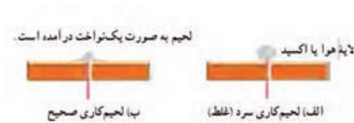
شکل ۵۰-۱- لحیم کاری صحیح و غلط
