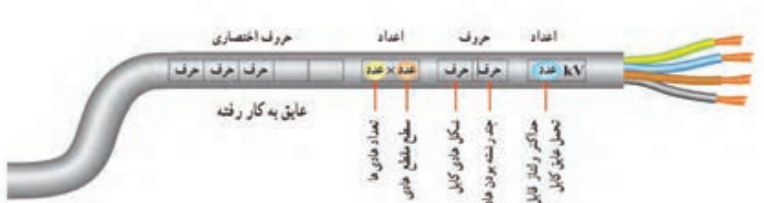
شکل ۱-۲ - مشخصات فنی یک نوع کابل
