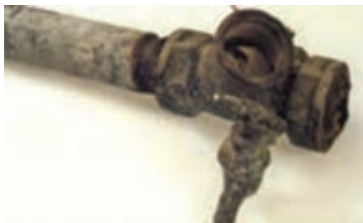
خوردگی لوله فولادی در نزدیکی محل تماس با شیر برنجی
