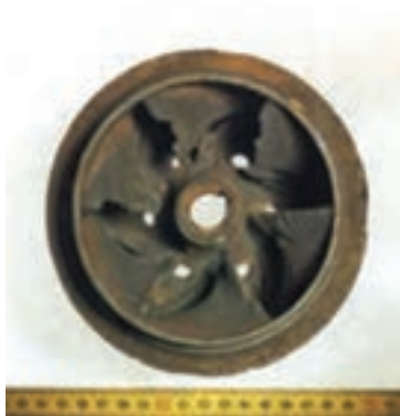
پره پمپ به دلیل قرار گرفتن در محلول خورنده حاوی ذرات ماسه دچار خوردگی فرسایشی شده است.
