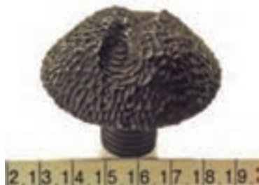
بیج در محلول خورنده حاوی ذرات ساینده دچار خوردگی فرسایشی شده است.
