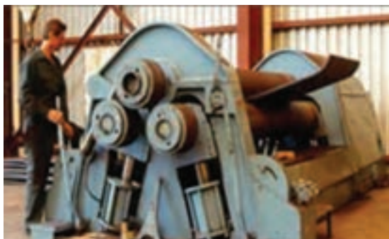
سطح غلتک‌های دستگاه نورد به دلیل نیروی مکانیکی دچار سایش می‌شود.
