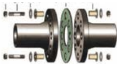
شکل ۳-۳۳ نحوه قرارگیری واشر آب‌بندی
