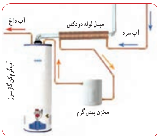
مبدل گرمایی (پیش گرم کن) گاز به مایع
