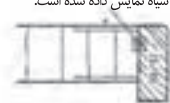
اتصال چسب با صفحات مصنوعی به وسیله چسب یا خطوط کوتاه و علائم استاندارد نمایش داده می شود.
