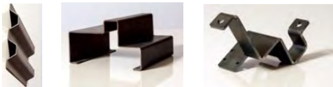
شکل ۶-۳ نمونه قطعات خم کاری
