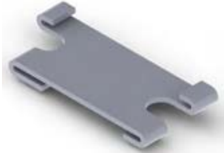
شکل ۳-۸ جهت‌های مخالف خم کاری
