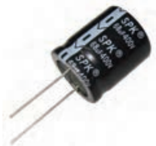
شکل ۱-۳۱ تصویری از یک خازن که روی آن ظرفیت و اختلاف پتانسیل قابل تحمل بیشینه نوشته شده است.
