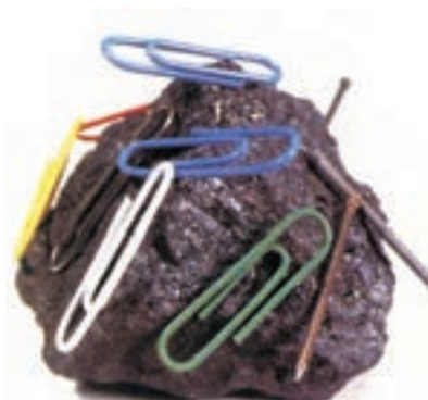
شکل ۲-۳ پدیده های مغناطیسی حدود ۲۵۰۰ سال پیش در تکه هایی از سنگ آهن مغناطیده در نزدیکی شهر مگنسیا (که نام امروزی آن مانیسا و در غرب ترکیه واقع است) مشاهده شد. این تکه ها نمونه هایی هستند از چیزی که امروز آهنربای دائمی خوانده می شود.
