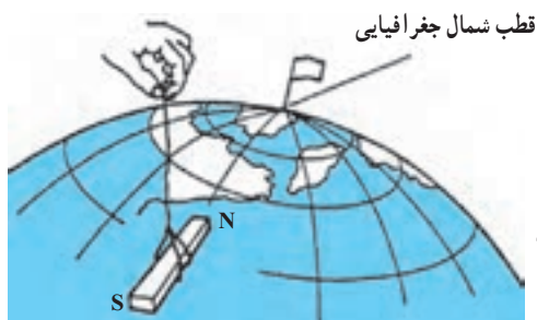
شکل ۴-۳ آهنربا در این وضعیت مانند یک قطب نما رفتار می کند.
