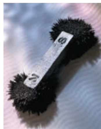
شکل ۳-۳ در یک آهنربا، به هر شکلی که باشد، دو ناحیه وجود دارد که خاصیت مغناطیسی در آنها بیش از قسمت های دیگر است.
