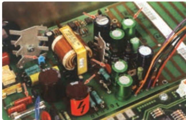
شکل ۱-۲۴ مدار یک تقویت کننده که شامل چند خازن است. برخی از خازن‌ها با پیکان مشخص شده‌اند.
