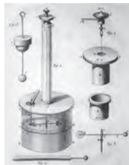
شکل ۱-۲ ترازوی پیچشی کولن. در دو سر یک میله سبک افقی یک کره کوچک و یک قرص قرار دارد. یک کره مشابه از حفره‌ای به داخل برده می‌شود. نیروی مؤثر بین بارها از اندازه‌گیری زاویه چرخش ترازوی پیچشی تارسیدن به تعادل به دست می‌آید. (تصویر از کتاب مرجع سال ۱۷۸۵ م.)
