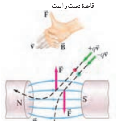
شکل ۳-۱۳ بر ذره باردار q یا -q که با سرعت \vec{v} در میدان مغناطیسی \vec{B} حرکت می‌کند نیروی مغناطیسی \vec{F} وارد می‌شود که جهت آن با قاعده دست راست تعیین می‌شود.
