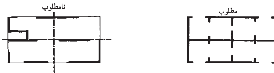
شکل ۱۰-۵ - نحوه‌ی قرارگیری دیوارها به طور منظم و متقارن در پلان ساختمان
