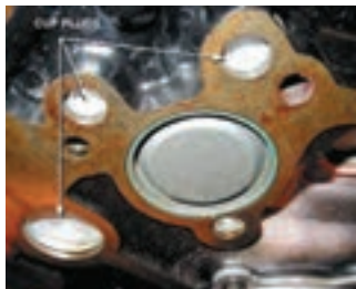
پولکی‌های نصب شده
