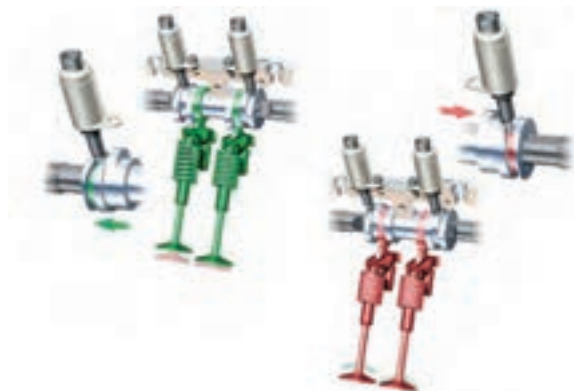
سرسیلندر با مکانیزم تایمینگ متغیر با تغییر در ارتفاع باز شدن سوپاپ‌ها (نوع الکترومغناطیسی دارای بادامک ارتفاع کم و زیاد با حرکت طولی بادامک‌ها)
