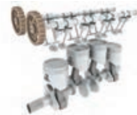
سرسیلندر آلایژ آلومینیومی با دو میل سوپاپ رو (هرسیلندر بیش از ۲ سوپاپ)
