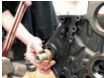
ابزار مخصوص و روش نصب پولکی
