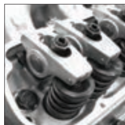
مجموعه اسبک های غلتکی در موتور OHV دارای تنظیم کننده هیدرولیکی و یا تاقان رولبرینگی
