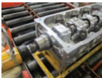
شکل ۵۶-۱ نحوه تعویض کاسه نمد میل سوپاپ با استفاده از ابزار مخصوص
