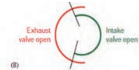
موقعیت میل سوپاپ ورودی در حداکثر آدوانس
