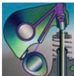
شماتیک اسبک با تنظیم‌کننده هیدرولیکی
