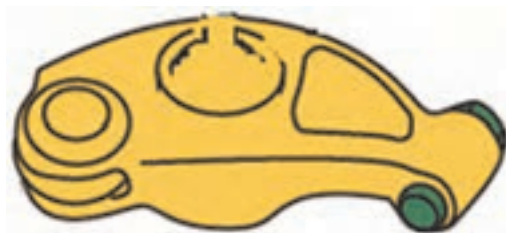
خوردگی و لقی غلتک را بازدید و بررسی کنید
