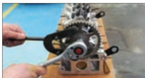
مراحل باز کردن چرخ تسمه
