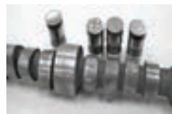
خوردگی تایپیت و بادامک های میل سوپاپ
