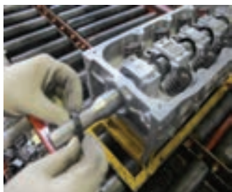
شکل ۵۶-۱ نحوه تعویض کاسه نمد میل سوپاپ با استفاده از ابزار مخصوص
