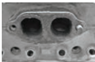
بریدن پیچ اتصال مانیفولد دود داخل سرسیلندر
