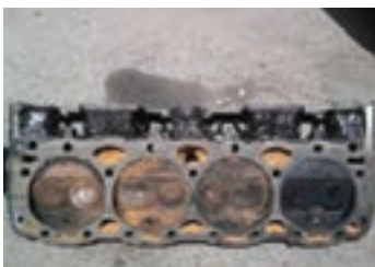
سوختن واشر سرسیلندر و ورود مایع خنک کننده به سیلندر ۱
