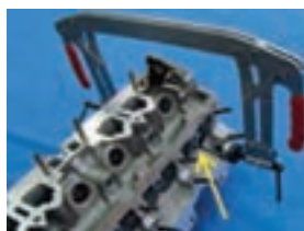
استفاده از فنر سوپاپ جمع کن مخصوص سرسیلندر موتور پژو XU7
