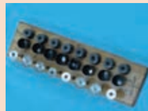
حفظ ترتیب تایپیتها و شیم های سوپاپ
