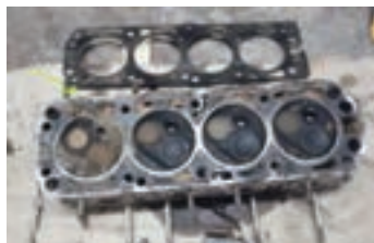
سوختن واشر سرسیلندر و ورود مایع خنک کننده به سیلندر ۱
