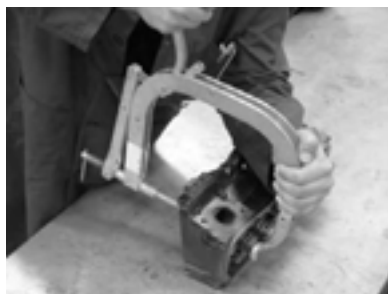
استفاده از فنر سوپاپ جمع کن دستی
