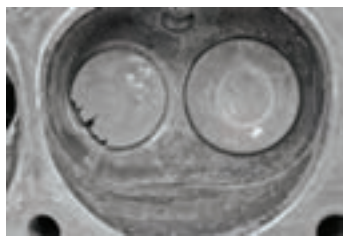
خوردگی سرسیلندر در ناحیه مجاری مایع خنک کننده
