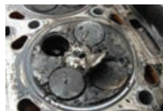
ذوب شدن سوپاپ
