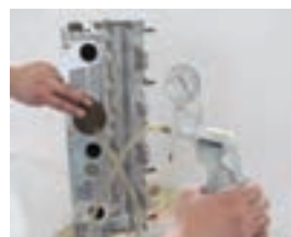
نشستی سنجی سوپاپ ها بوسیله دستگاه خلا سنج
