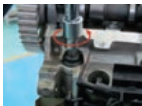
جهت باز کردن پیچ های سرسیلندر
