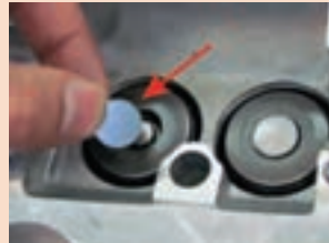
خروج شیم زیر تایپیت شکل ۸۲-۱
