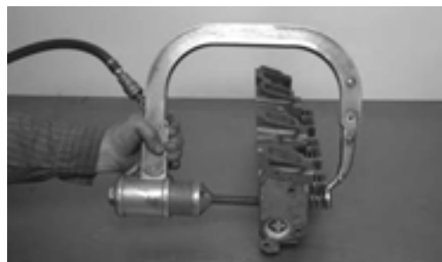
استفاده از فنر سوپاپ جمع کن پنوماتیکی
