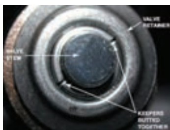
پس از جمع کردن فنر سوپاپ، خارهای نگهدارنده خارج می شوند
