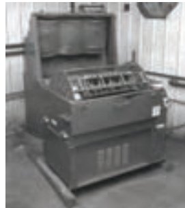
دستگاه شات بلاست اتوماتیک
