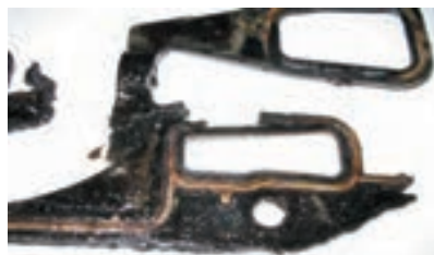
سوختن واشر آب بندی مانیفولد
