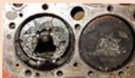
ذوب شدن پیستون
