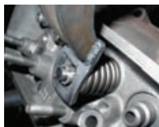
پس از جمع کردن فنر سوپاپ، خارهای نگهدارنده خارج می شوند
