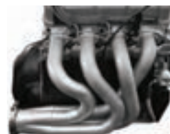
کنترل مانیفولد خروجی (فولادی)
