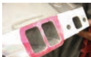
تابیدگی در مانیفولد ورودی
