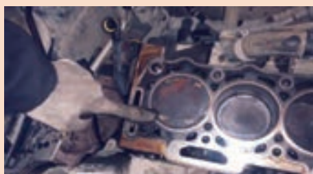
بر خورد سوپاپ‌ها به سر پیستون
