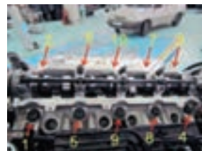
ترتیب باز کردن پیچ های سرسیلندر
