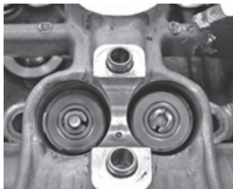
شکل ۱-۱۱۵ نصب نادرست خارهای سوپاپ
