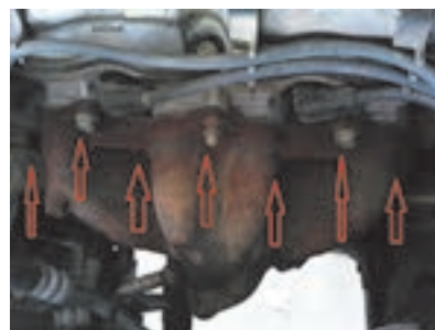
تصویر نشستی بین مانیفولد و لوله اگزوز
