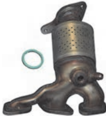
مجموعه مانیفولد خروجی و کاتالیست
