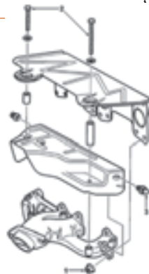
انفجاری سپرهای حرارتی و مانیفولد دود
