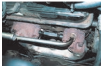
تصویر نشستی دود بین مانیفولد و سرسیلندر
