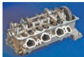
محل نصب مانیفولد خروجی روی سر سیلندر
