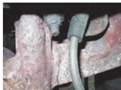
تصویر شکستگی مانیفولد
