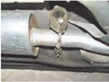
بررسی بست‌های نگهدارنده سیستم اگزوز
