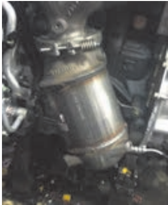
محل نصب مانیفولد خروجی و کاتالیست روی موتور خودرو
