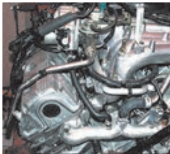
محل نصب EGR روی موتور خودرو
