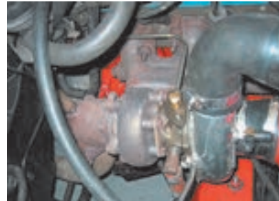
محل نصب توربو شارژر روی موتور
