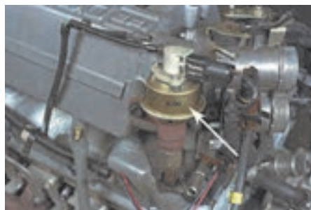
محل نصب EGR روی موتور خودرو
