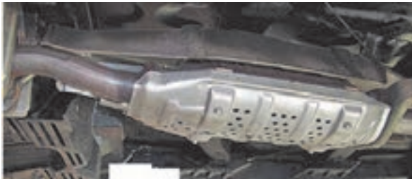
شکل ۲۷-۲ محل نصب سپر حرارتی در سیستم اگزوز
