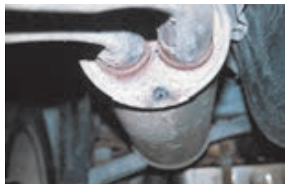
تصویر سوراخ شدن کاتالیست
