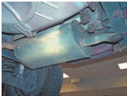
شکل ۳-۳۵ اتصال انباره اگزوز توسط بست‌های نگهدارنده لاستیکی
