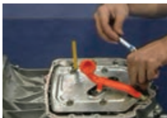
باز کردن صافی روغن ورودی به پمپ
