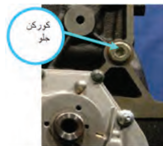
نصب پیچ‌های کورکن روی بلوک
