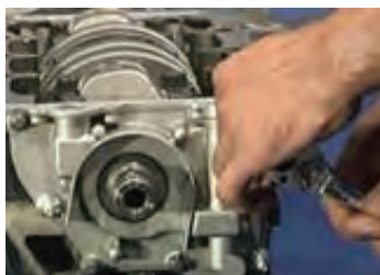
نصب مجموعه روغن بر روی بلوک سیلندر
