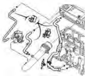
نصب لوله ها و شلنگ های بخارات روغن
