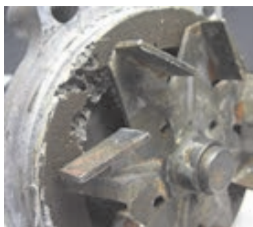
خرابی بلبرینگ و خوردگی داخلی
