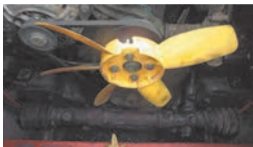
وجود شکستگی یا ترک پره ها
