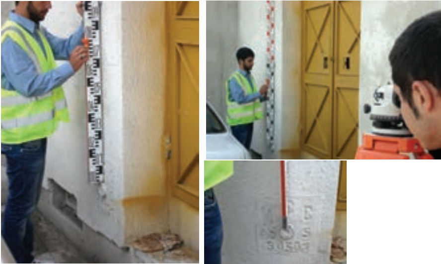
▲ شکل ۱-۱ – ترازیابی از یک نقطه پنج مارک
