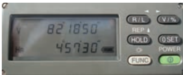
▲ شکل ۲-۶- نمایش زاویه افقی و قائم
