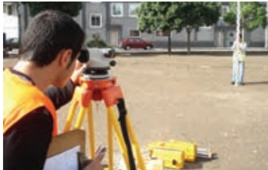
▲ شکل ۳-۲- فاصله‌یابی به روش استادیمتری
