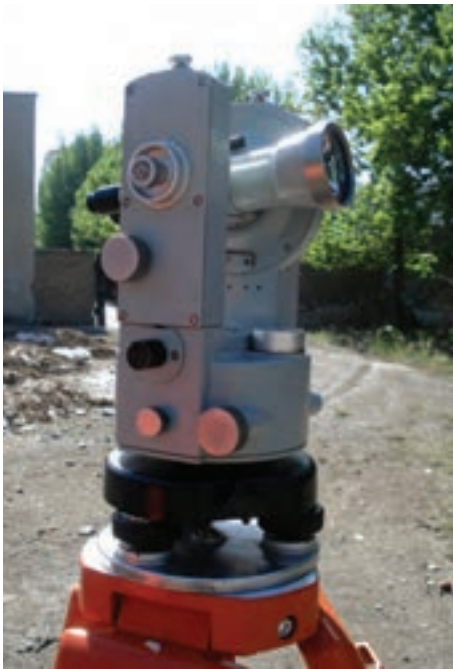
شکل ۲-۵ - دوربین زاویه یاب آنالوگ و دیجیتال
