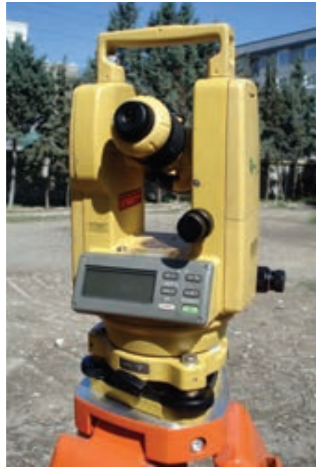
شکل ۲-۵ - دوربین زاویه یاب آنالوگ و دیجیتال
