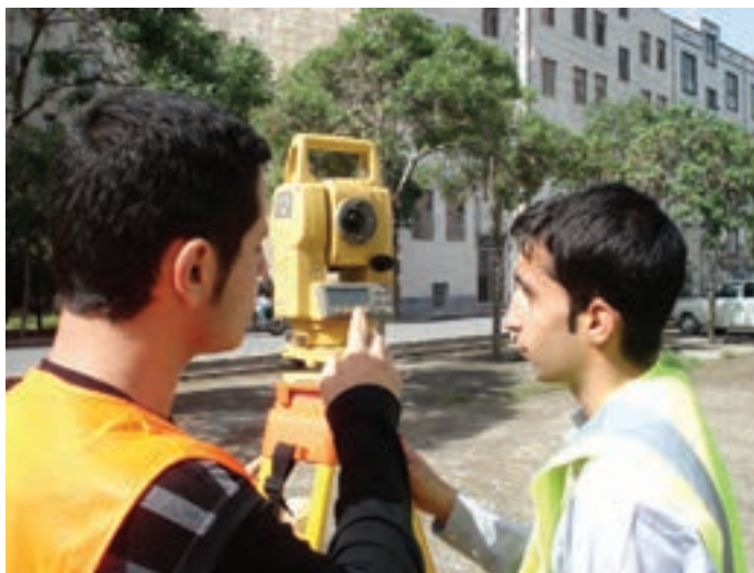
▲ شکل ۶-۲- آشنایی با اجزای توتال استیشن تاپکن GTS-۲۲۰
