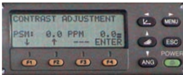
▲ شکل ۶-۴- کلیدها و صفحه نمایش توتال استیشن تاپکن سری GTS-۲۲۰
