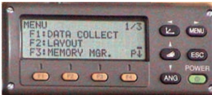
▲ شکل ۶-۱۴- ورود به منوی DATA COLLECT
