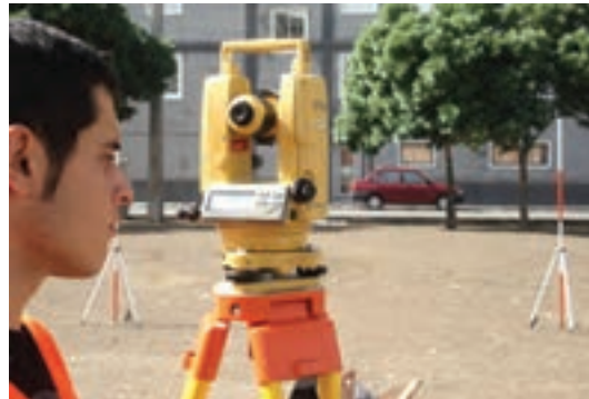
▲ شکل ۲-۱۷- نشانه روی و قرائت امتدادها در حالت دایره به راست دوربین
