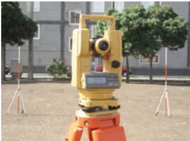
▲ شکل ۲-۱۵- نشانه‌روی و قرائت با زاویه‌یاب دیجیتال
