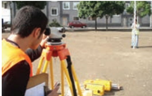
▲ شکل ۳-۲- فاصله‌یابی به روش استادیمتری
