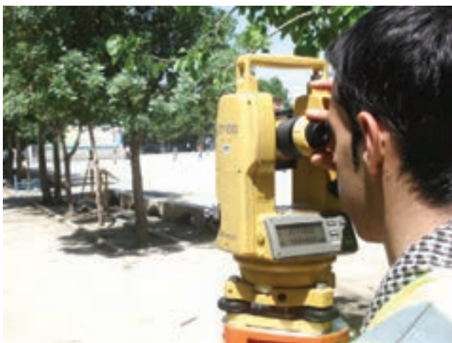
▲ شکل ۵-۳- هنگام شروع عملیات زاویه‌خوانی، دوربین در حالت دایره به چپ باشد.
