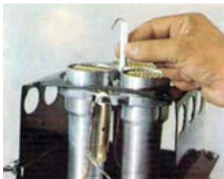
شکل ۳۵- ۵- تعویض الکتروود جرقه
