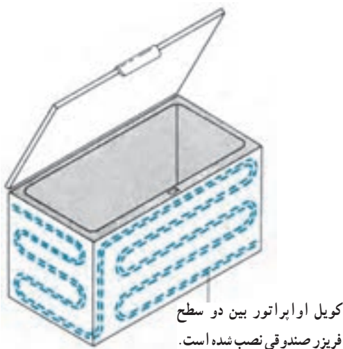
شکل ۶-۶ اوپراتور صفحه‌ای در دستگاه فریزر صندوقی
