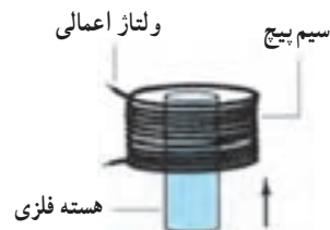
شکل ۷-۱۰- سیم پیچ به علاوه هسته فلزی شیر برقی
