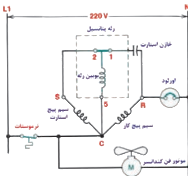
شکل ۸-۱- مدار الکتریکی آب سردکن
