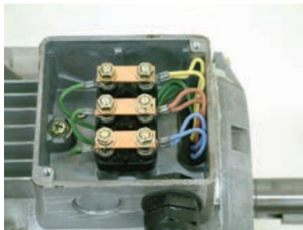
شکل ۱۴-۹- اتصال مثلث سیم پیچ های موتور
