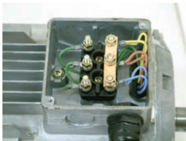
شکل ۹-۱۳- اتصال ستاره سیم‌پیچ‌های موتور
