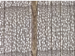
شکل ۲۰-۱- مرز نامشخص بین چوب بهاره و تابستانه در مقطع عرضی میکروسکوپی
