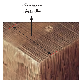
شکل ۲۷-۱ - حفره تراکتیدی در بخش بهاره و تابستانه در سوزنی برگ (کاج)
