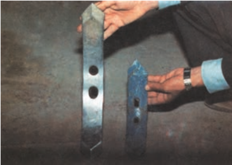
شکل ۳-۶ - انواع تیغه‌های گاو آهن قلمی (چیزل)
