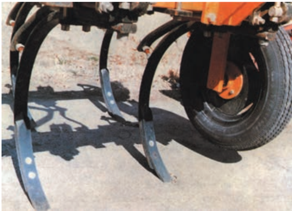
شکل ۱-۶- گاو آهن قلمی (چیزل)
