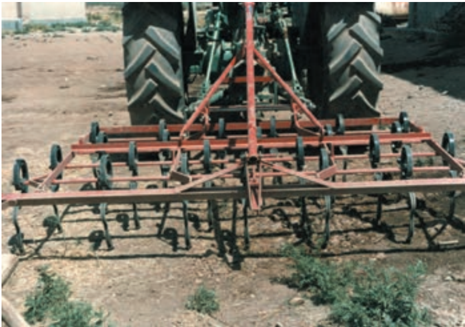
شکل ۷-۶ - کولتیواتور شاخه فنری
