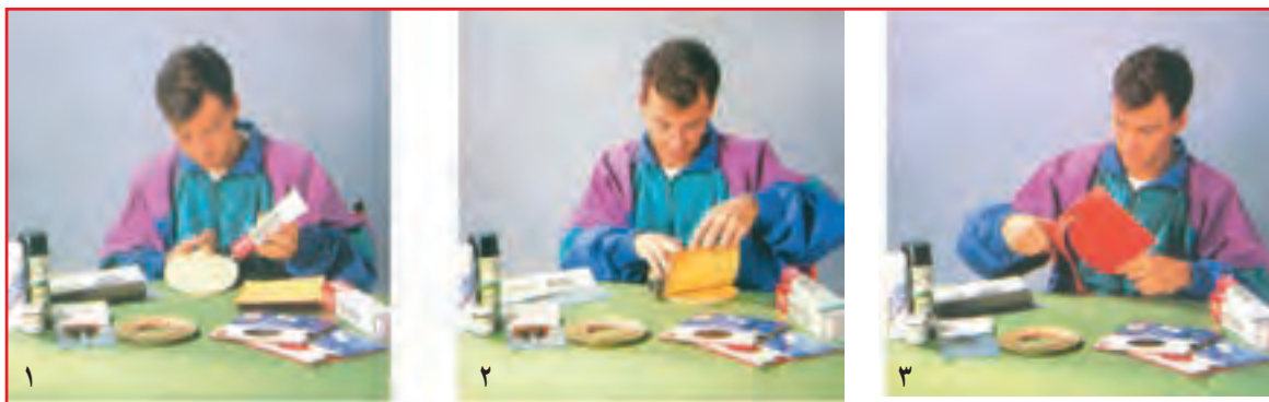
شکل ۳-۲- طریقه‌ی چسباندن رویه‌ی راکت
