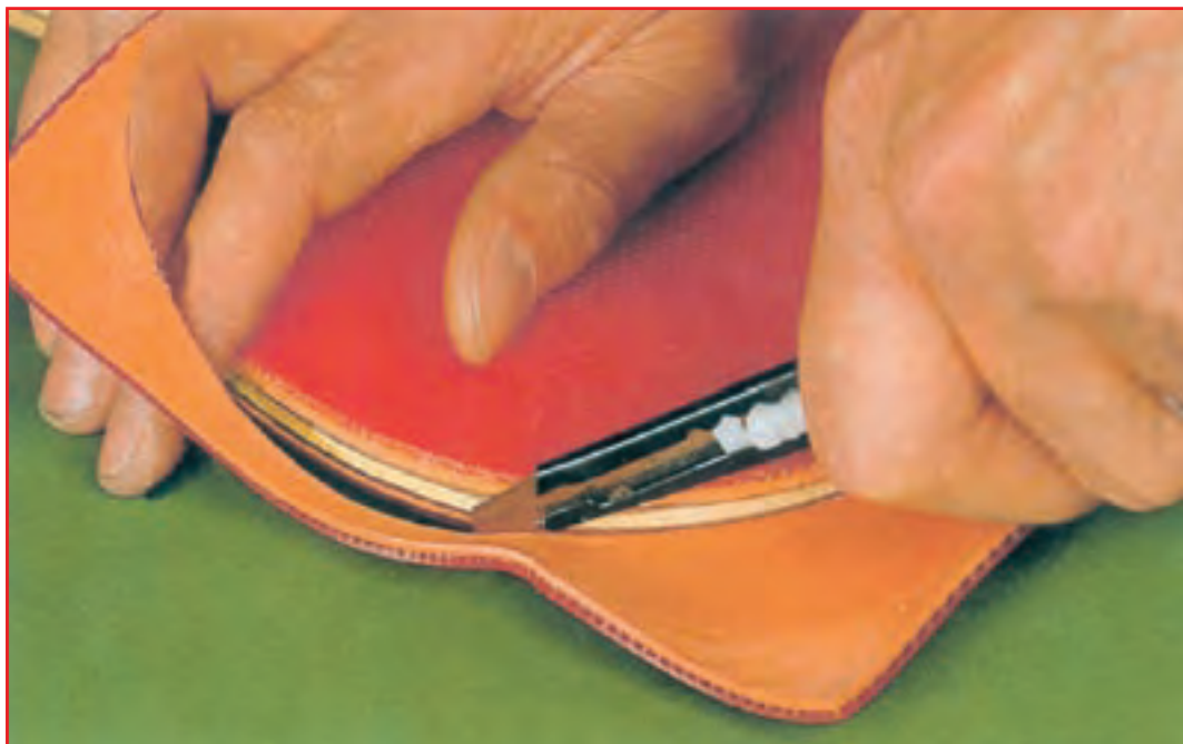
شکل ۴-۲- طریقه‌ی بریدن رویه‌ی راکت با کاتر (تیغ موکت‌بری)
